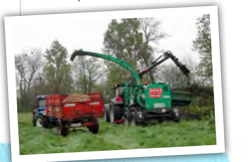
Déchetage des branches coupées.
